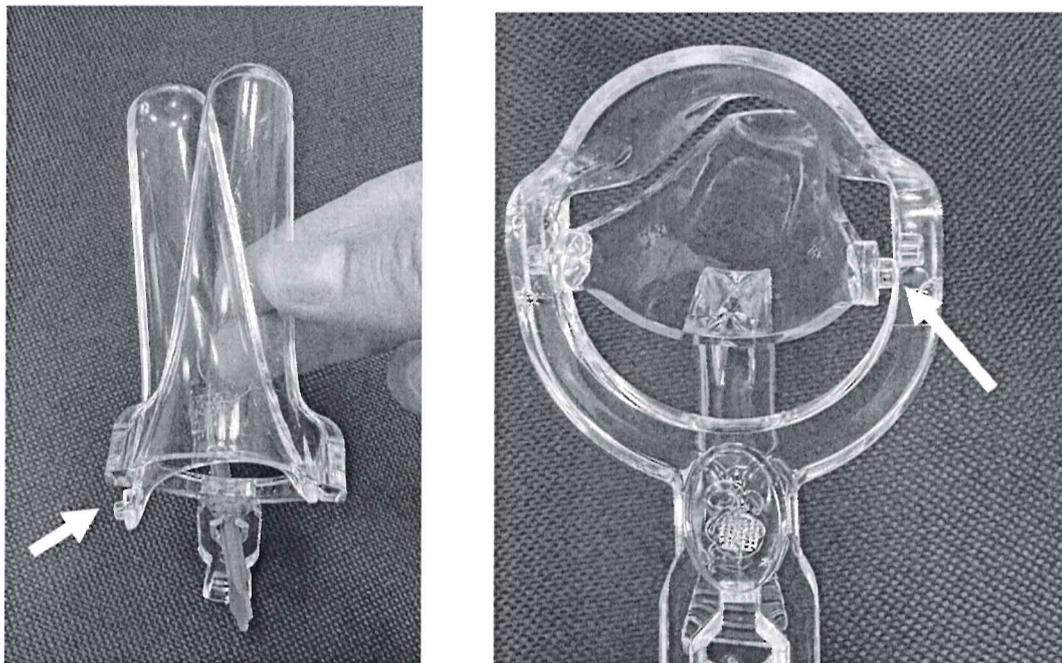
Данный дефект является последствием неправильной ручной сборки зеркала гинекологического: нижняя створка зеркала не до конца вставлена в паз соединения верхней створки.
